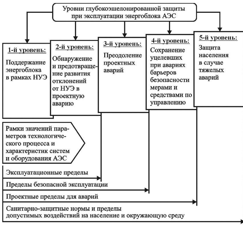
Рис. 1.5. Взаимосвязь уровней глубокоэшелонированной защиты и пределов безопасной эксплуатации АЭС
