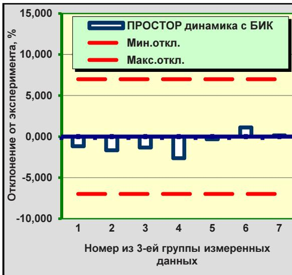
Рис. 4.24. Относительное отклонение расчетного веса отдельных групп ОР СУЗ в динамике по БИК от измеренного для третьей группы данных на мощности
