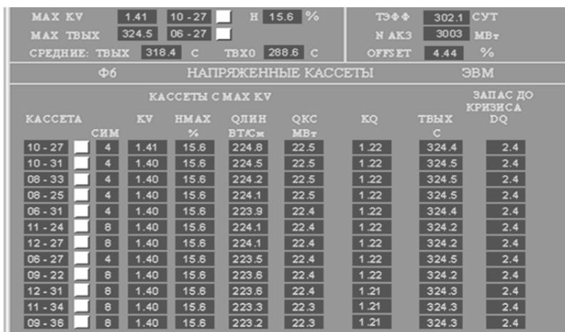
Рис. 4.28. Фрагмент для отображения параметров в двенадцати ТВС с максимально-напряженными участками активной зоны
