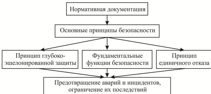
Рис. 1.1. Связь нормативной документации, принципов безопасности с предотвращением и ослаблением аварий
