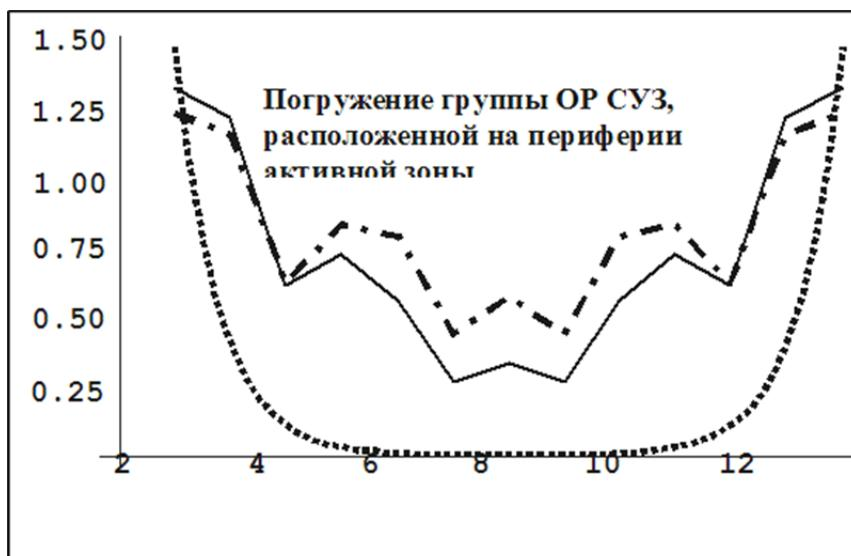
Рис. 4.6. Пространственная зависимость чувствительности БИК к нейтронам деления в активной зоне и радиальная зависимость распределения нейтронов деления в активной зоне при погружении шестой группы ОР СУЗ
