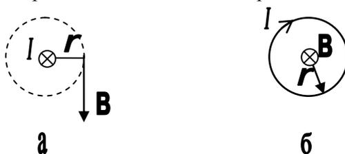
Рис. 24.1. Индукция магнитного поля, создаваемого: а – прямым проводником с током; б – круговым проводником с током.
