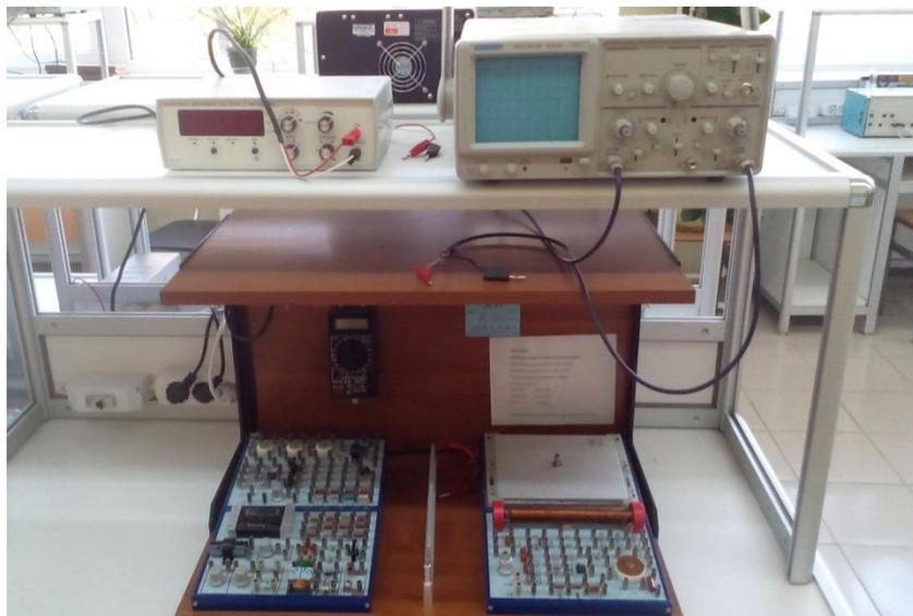
Рис. 27.1 Вид установки (на столе – лабораторный комплекс с разборным конденсатором; на полке: слева – звуковой генератор, справа – осциллограф)
