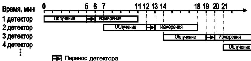
Длительность облучения – 5 минут, перенос детектора из экспериментальной установки в счетчик бета-частиц – 1 минута, измерение числа испущенных детектором бета-частиц – 5 минут. *Следует по возможности точно соблюдать выбранные временные интервалы, так как введение поправок на отклонения от них не предусмотрено.*
