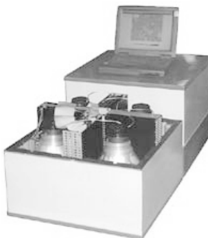
Рис. 8.1. Внешний вид аэрогамма-спектрометра АГСК-99С МИФИ
