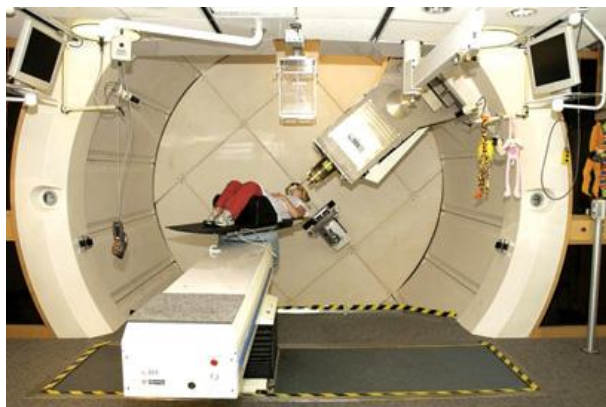
Рис. 13. Установка для облучения протонами
