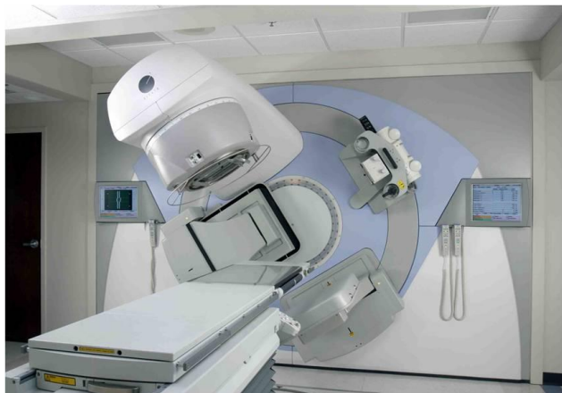
Рис. 12. Установка для облучения фотонами и электронами
