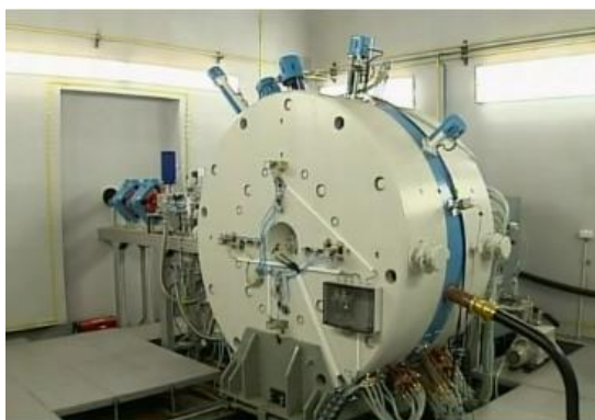
Рис. 14. Установка для облучения нейтронами
