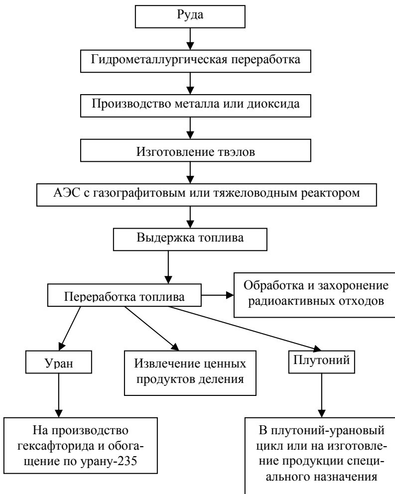
Рис. 2. Принципиальная схема ядерного топливного цикла с использованием природного урана
