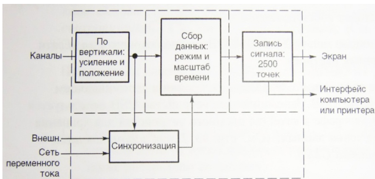
Рис.1.6. Блок-схема различных функций осциллографа и их связей друг с другом
