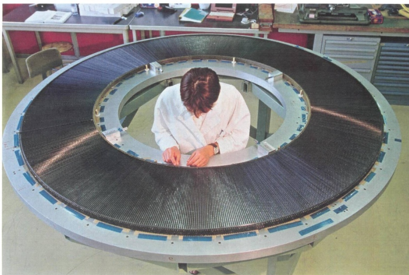
Монтаж элемента детектора TRT установки АТЛАС в монтажном зале CERN. 2002 г.
