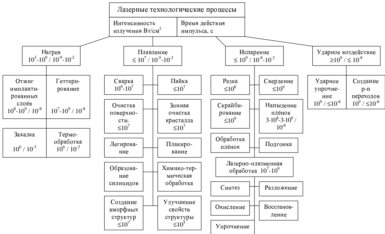
Рис. 1: Классификация лазерных технологических процессов по плотности мощности
