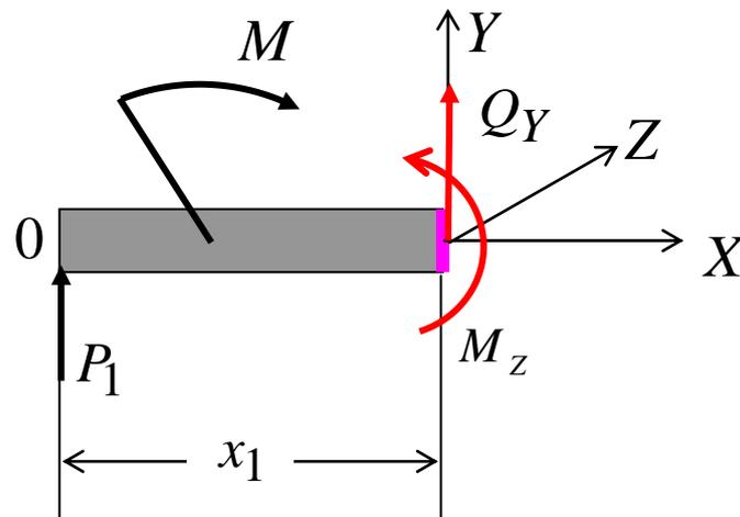
Запишем уравнения равновесия для сил и моментов относительно оси  $Z$ :
