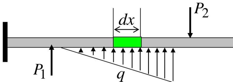
На малом отрезке  $dx$  распределенную нагрузку  $q$  можно считать постоянной. Тогда по граням выделенного элемента будут действовать следующие силы и моменты.
