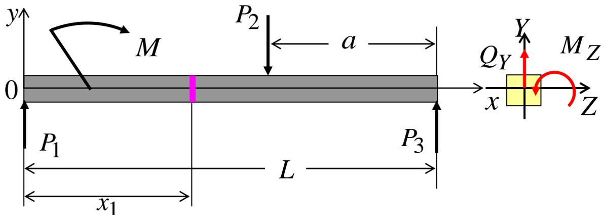
При таком нагружении бруса в его поперечных сечениях возникают изгибающие моменты  $M_Z$  и поперечные силы  $Q_Y$ . Эти внутренние силовые факторы определены в системе координат  $X, Y, Z$ , связанной с центром тяжести сечения, координатные оси – главные центральные оси сечения.
