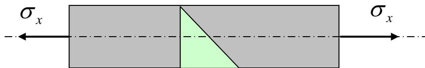
Выделим элемент стержня посредством сечения нормальной и наклонной плоскостями и рассмотрим условия его равновесия.
