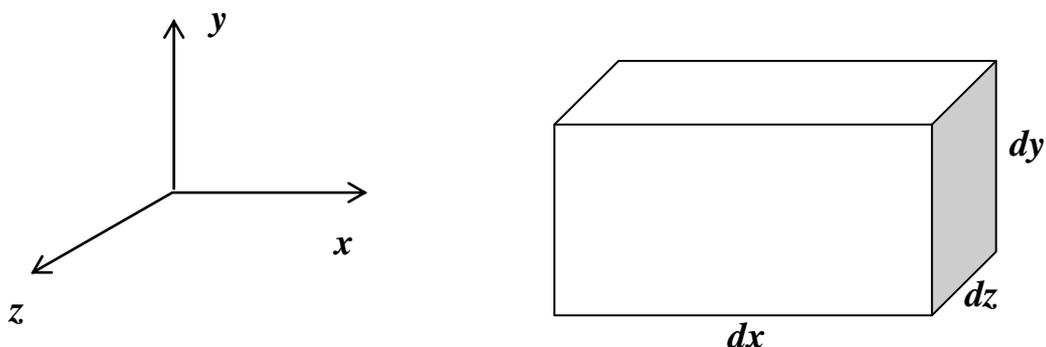
Под действием сил произойдет изменение размеров граней. Спроектируем исходный и деформированный параллелепипеды на плоскость  $x - y$ .
