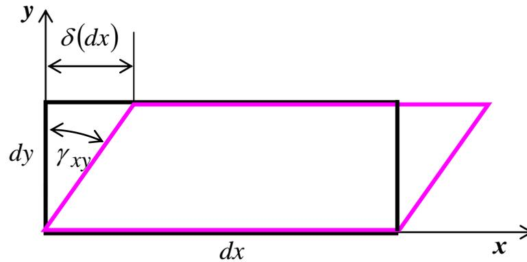
Определим угловую деформацию  $\gamma_{xy}$  как меру изменения прямого угла, в данном случае угла между осями  $x$  и  $y$  :
