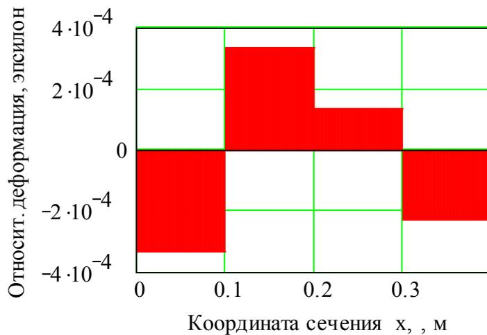
Вычислим отдельно удлинения для каждой из четырех частей стержня
