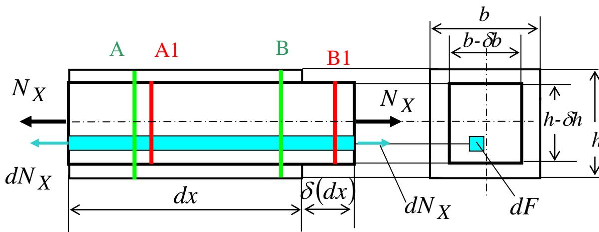
В соответствии с гипотезой плоских сечений, сечения, плоские до нагружения останутся плоскими и после приложения сил. Так сечение А займет положение сечения А1, а сечение В – положение В1, но останутся плоскими. При растяжении сечения останутся и параллельными.
