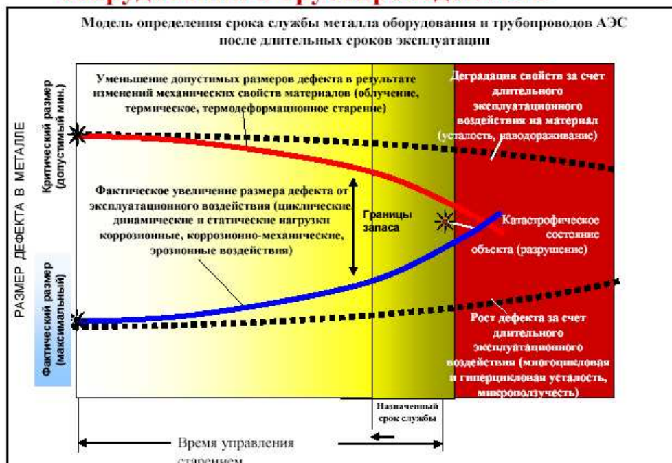
Рис. Л31.4. Модель определения срока службы металлоконструкций
