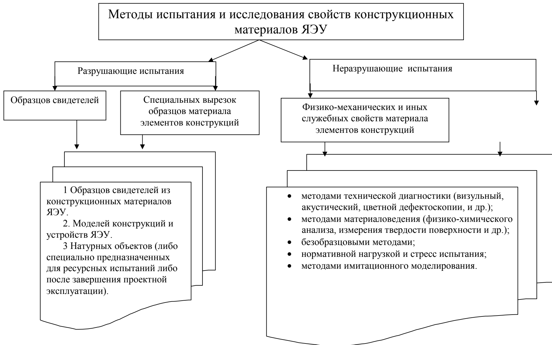
Рис. Л31.2. Система классификации методов контроля и испытаний материалов ЯЭУ для любого этапа их жизненного цикла
