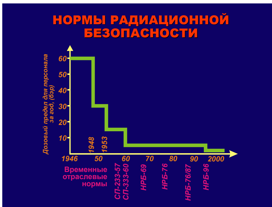
Рис. Л29.3. Динамика изменения допустимых пределов и норм безопасности для ОИАЭ в
