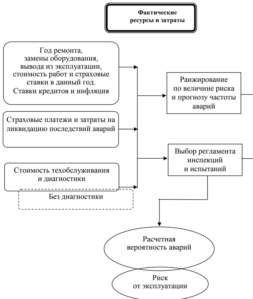
Рис. Л26.2. Диаграмма взаимосвязи факторов, определяющих оптимизацию объема и сроков диагностических работ, ремонта, замены оборудования и технического обслуживания
