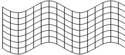
Смещение частиц среды при распространении поперечной (сдвиговой) волны
