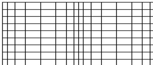
Смещение частиц среды при распространении продольной волны
