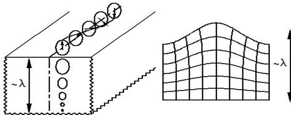
Смещение частиц среды при распространении поверхностной волны
