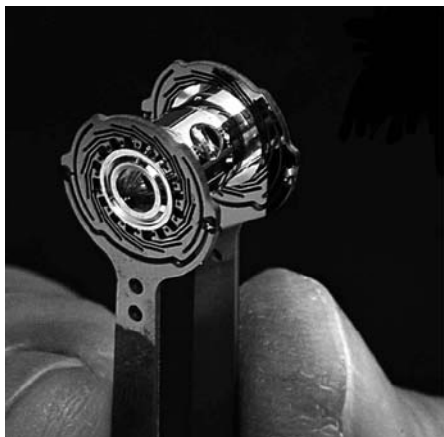
Рис. В3. Мишенный узел для экспериментов по инерциальному термоядерному синтезу (National Ignition Facility (NIF). Los Alamos)
