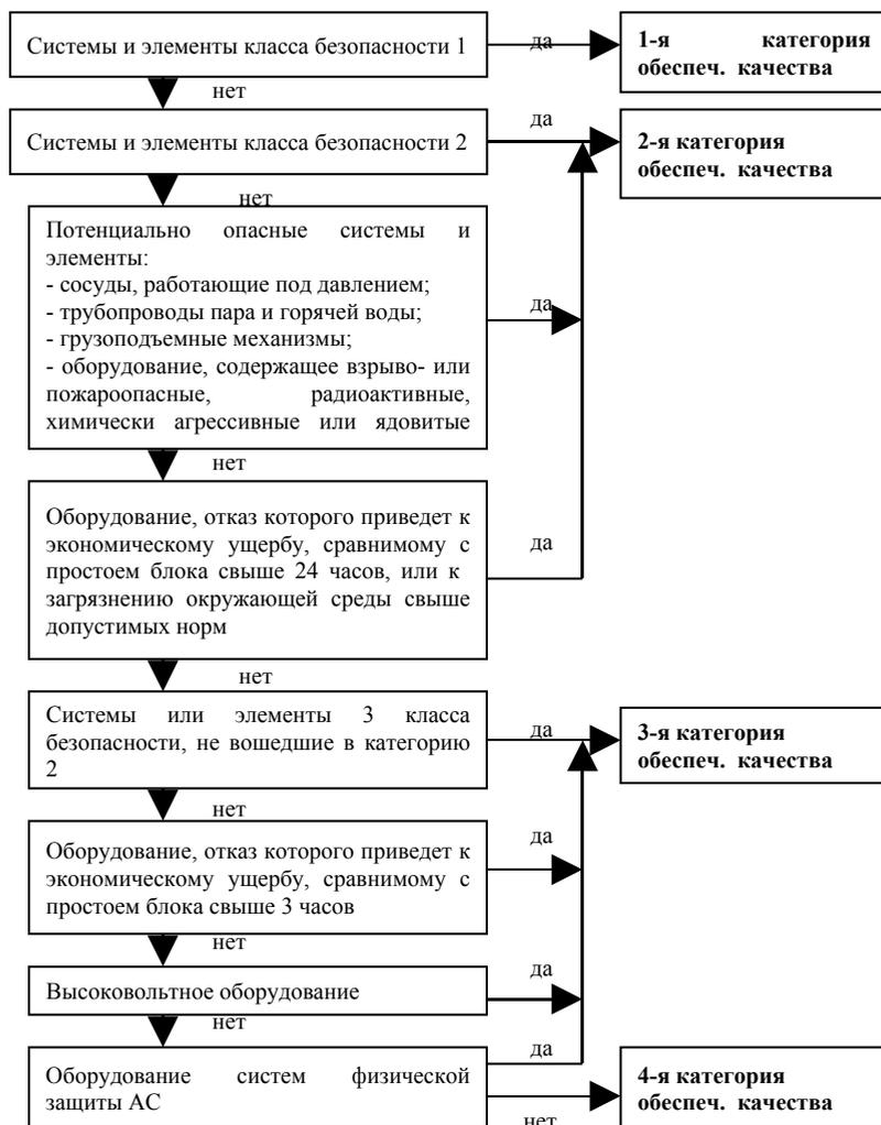
Рис. 1.2. Схема определения категории обеспечения качества для оборудования [244].
