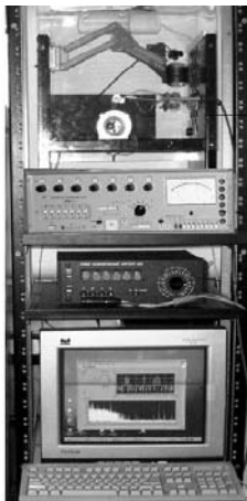
Рис.2.16. Внешний вид ИИС для исследования усталостных повреждений в металлических пластинах электрофизическим методом (разработана совместно с Обориным С.Б.)
