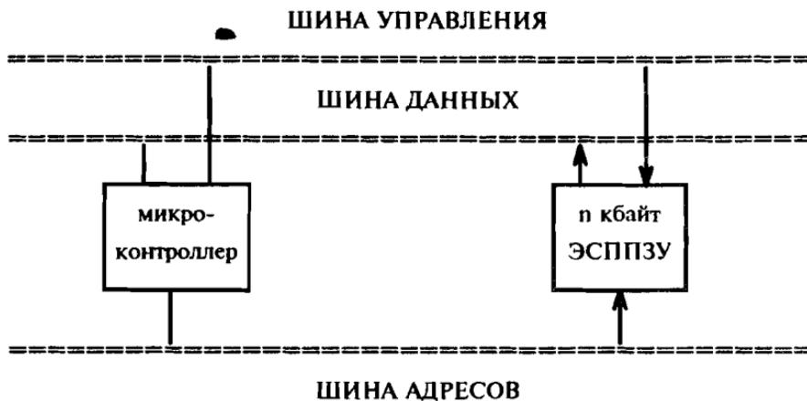
Рис. 1. Структурная схема карточки с защищенной полупроводниковой памятью
