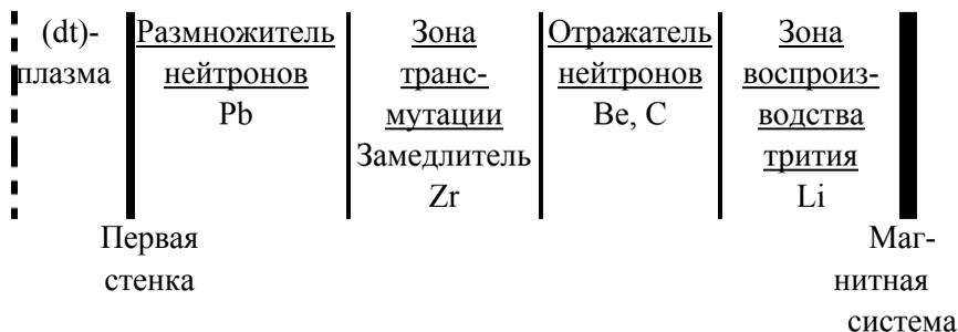
Рис.П.1.13. Схема blankets термоядерной установки типа ITER на основе (dt)-реакции синтеза для трансмутации  $^{93}\text{Zr}$
