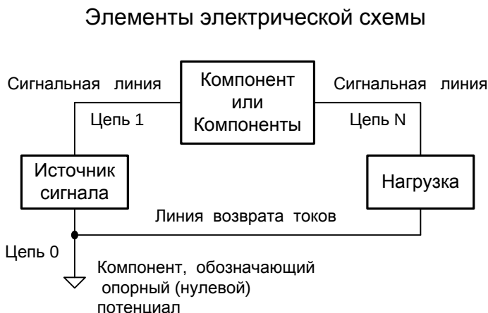
Рис. 7.1. Условная структура принципиальной схемы
