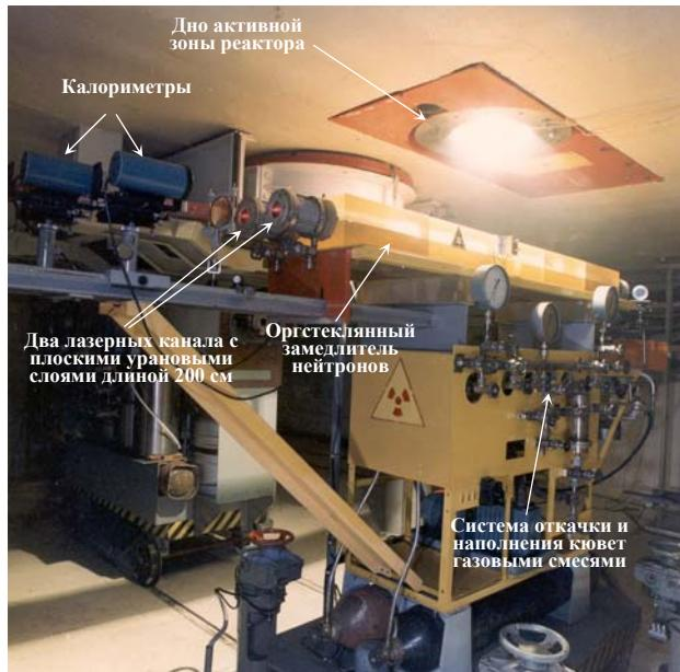
Рис.3.9. Установка ЛУНА-2М в нижнем зале реактора ВИР-2М [18,26]
