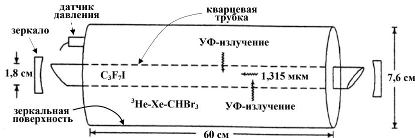
Рис.4.9. Схема кюветы, которая использовалась для накачки йодного лазера радиолюминесцентным излучением молекул XeBr [116]
