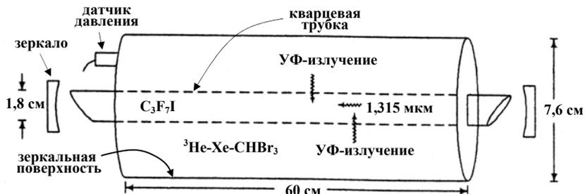
Рис.4.9. Схема кюветы, которая использовалась для накачки йодного лазера радиолумinesцентным излучением молекул ХеВг [116]
