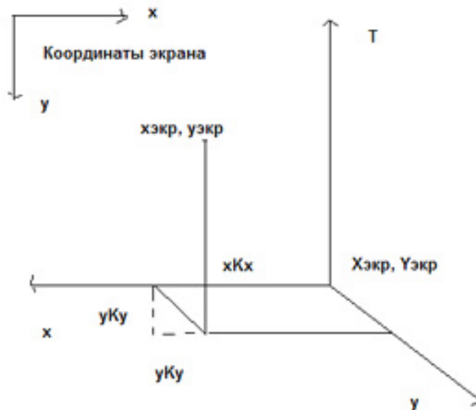
Рис. 6. Положение координат трехмерного пространства на плоском экране
