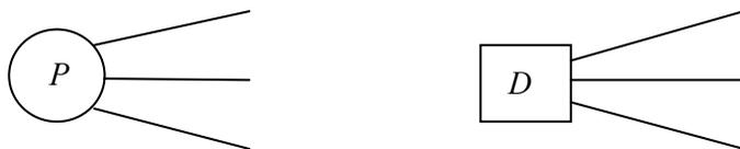
Рис. 1.16. Узлы событий  $P$  и узлы решений  $D$
