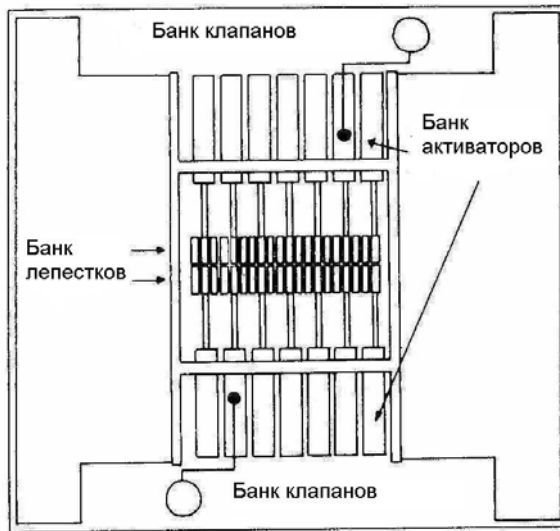
Рис.1.19. Схематическое изображение лепестков коллиматора MIMiC [14]
