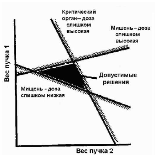
Рис. 2.3. Пример ограничений, определяющих допустимую область решений для двух пучков
