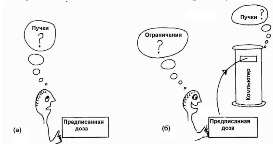
Рис. 2.2. Различие между концепциями прямого и обратного планирования: а) — планировщик, который получил идеальное дозовое предписание, использует свой опыт, чтобы определить наилучшее распределение весов для пучков; б) — планировщик, который получил предписание и ограничения для заданной задачи, использует компьютер для поиска оптимального плана облучения, решающего обратную задачу [2]
