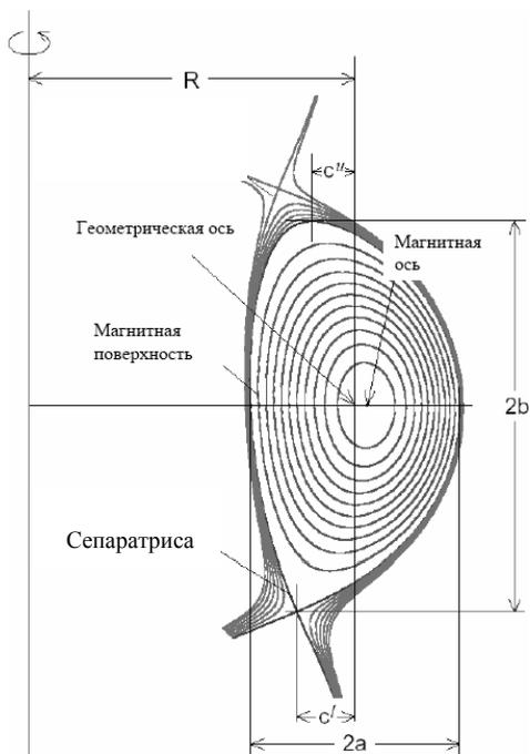
Рис. 2. Схематическое изображение поперечного сечения плазменного шнура с обозначением геометрических характеристик [2]
