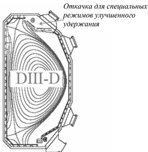
Рис 102. Одна из ранних модификаций дивертора установки DIII-D [5]
