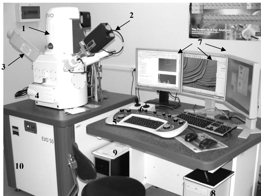
Рис.1.6. Внешний вид современного растрового аналитического микроскопа: 1 – колонна, 2 – энергодисперсионный спектрометр (EDS), 3 – волнодисперсионный спектрометр (WDS), 4 – шлюз, 5 – управляющая панель, 6 – джойстик, 7 – основной и вспомогательные мониторы, 8 – системный блок ЭВМ микроскопа, 9 – системный блок ЭВМ EDS и WDS, 10 – блоки питания, высоковольтный трансформатор, система вакуумной откачки
