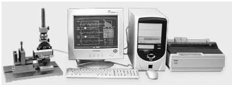
Рис.1.9. Внешний вид профилометра, оснащенного ЭВМ
