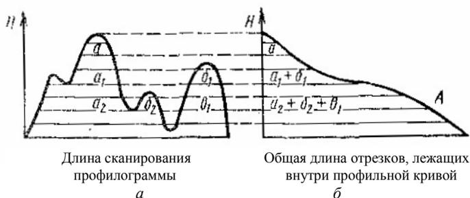
Рис. 1.4. Изменение площади контакта поверхности с деталью: а – профильная кривая, б – кривая несущей поверхности
