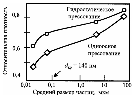
Рис. 21.16. Зависимость плотности прессовок порошков никеля от среднего размера частиц при давлении прессования 1 ГПа при одноосном и гидростатическом прессовании
