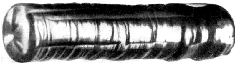
Рис. 17.12. Внешний вид монокристалла вольфрама, полученного методом плазменно-дуговой плавки
