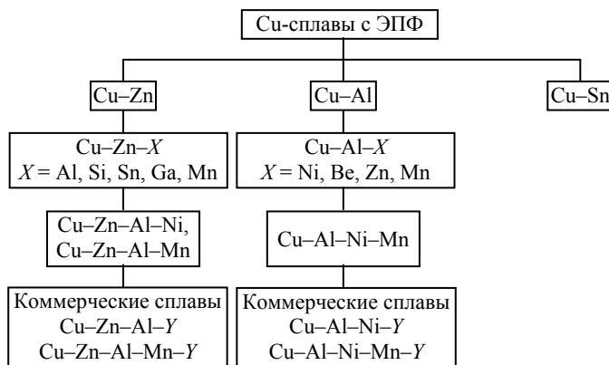
Рис. 22.35. Классификация сплавов с ЭПФ на основе меди (Y – модифицирующие элементы: В, Се, Со, Fe, Ti, V, Zr)
