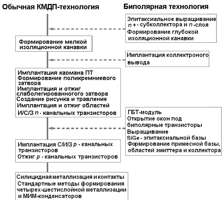
Рис. 4.3. Структура БиКМОП технологического процесса
