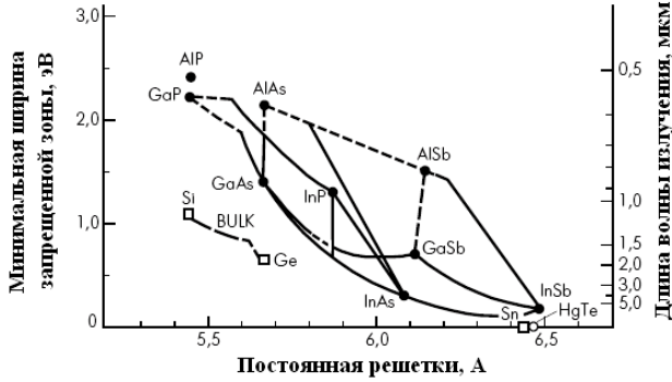
Рис 3.2. Минимальная ширина запрещенной зоны и постоянная решетки полупроводников группы A_3B_5 . Сплошная линия – прямой переход, пунктирная – не прямой переход
