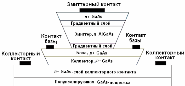
Рис 3.6. Типовая структура GaAs ГBT
