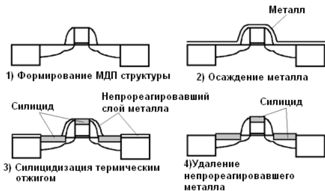
Рис. 7.16. Последовательность операций “Salicide”
