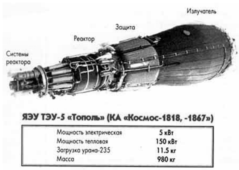
Рис.2.2. Ядерная энергетическая установка
