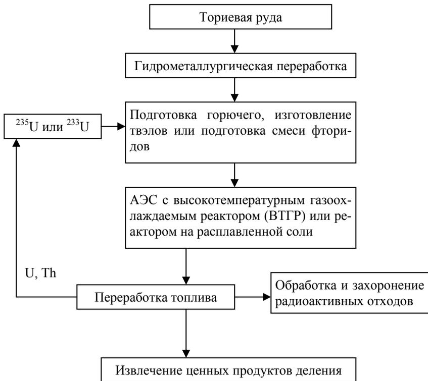
Рис. 4. Принципиальная схема уран-ториевого топливного цикла
