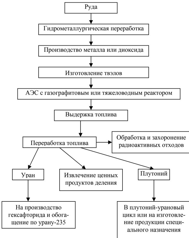
Рис. 2. Принципиальная схема ядерного топливного цикла с использованием природного урана
