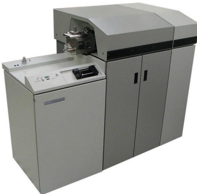
**Рис. 3.3.** Внешний вид аналитической стойки квадрупольно-времяпролетного масс-спектрометра QStar Elite (Sciex Applied Biosystems, Канада)
