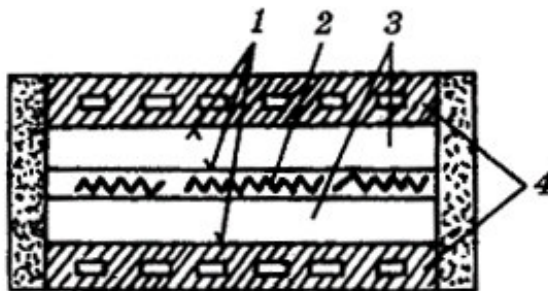
Рис.1.4. Схема измерения коэффициента теплопроводности методом плоского слоя с двумя образцами: 1 – термопары; 2 – основной нагреватель; 3 – образец; 4 – теплосъемник
