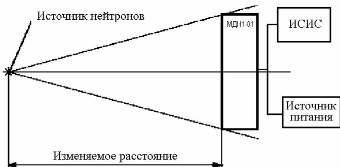
Рис. 8.9. Схема проведения эксперимента с источником нейтронов без использования теневого конуса (ИСИС – система сбора и обработки информации)
