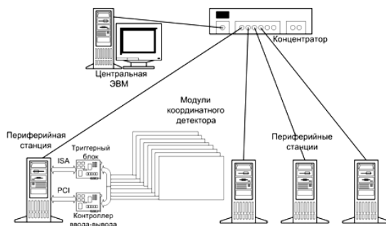
Рис. 1.11. Функциональная блок-система сбора данных и триггирования
