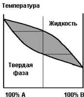
Рис.3.10. Диаграмма состояния двух металлов  $A$  и  $B$
