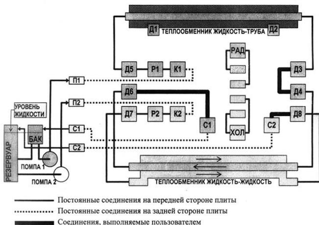
Рис. 6.2. Схема гидравлических соединений при встречном течении жидкостей
