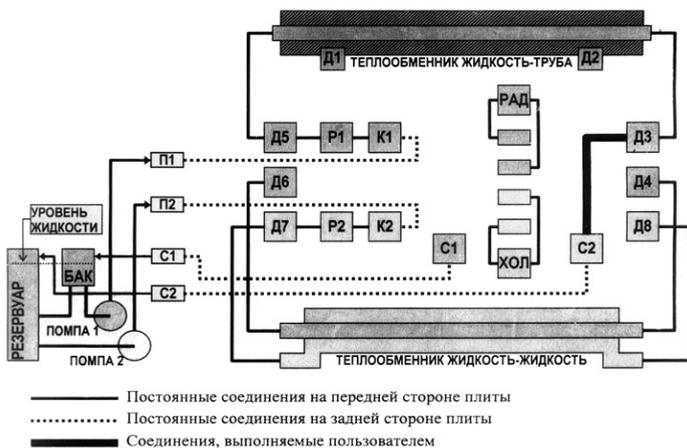
Рис. 5.1. Схема экспериментальной установки
