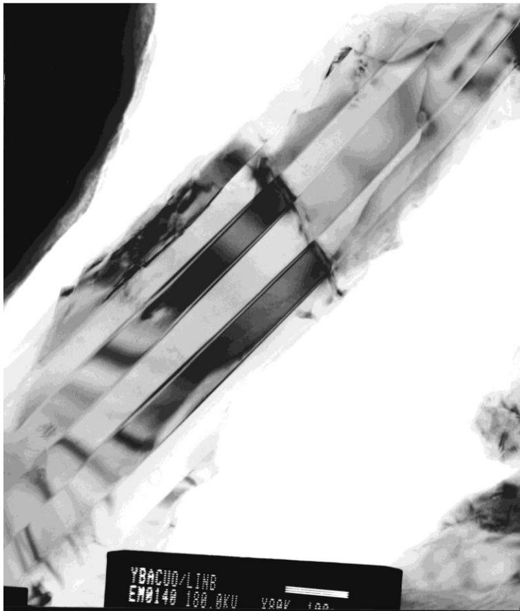
Рис. 1.3. Изображение двойниковой структуры поперечным размером  $30 \div 40$  нм в кристаллите пленки  $\text{YBa}_2\text{Cu}_3\text{O}_{7-x}$
