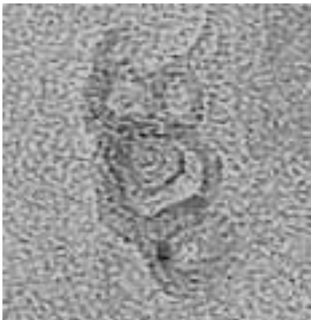
Рис. 3.2. Микрофотография onions, полученная с помощью ПЭМ (увеличение 600000 раз)
