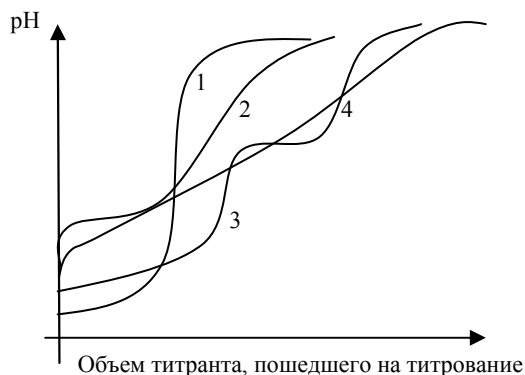
Рис. 2. Кривые потенциометрического титрования катионитов: 1 – сильнокислотный катионит; 2 – слабокислотный катионит; 3 – полифункциональный ионит; 4 – катиониты, представляющие собой смеси многих кислот различной силы
