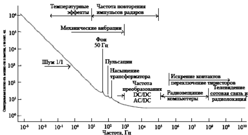
Рис. 3.5. Относительный уровень спектральной плотности мощности и частоты основных источников электромагнитных помех
